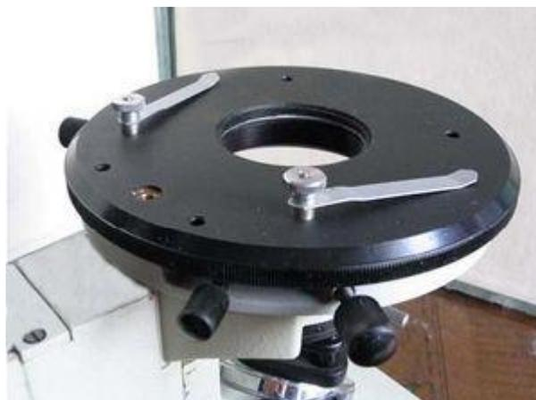
**Рис. 3. Центрируемый предметный столик**
