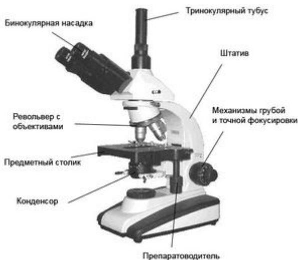
Рисунок 1. Устройство микроскопа
