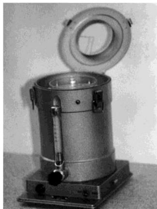
Рис. 1. Прибор Кротова для бактериологического исследования воздуха
